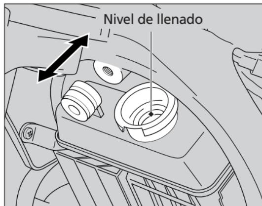
Si el nivel del refrigerante baja de forma evidente, es probable que tenga una fuga grave. Haga inspeccionar la motocicleta en su concesionario.
