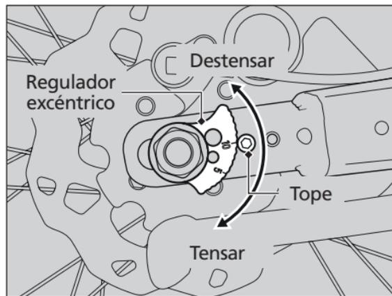
5. Gire el regulador excéntrico hacia una posición con numeración superior para reducir el juego libre de la cadena o hacia una posición con numeración inferior para aumentarlo.
