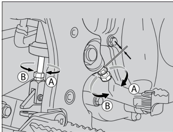
Para ajustar la altura del pedal del freno trasero:
