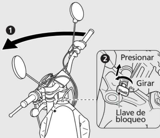
La cerradura de bloqueo de la dirección está en el puente inferior de la suspensión delantera.
