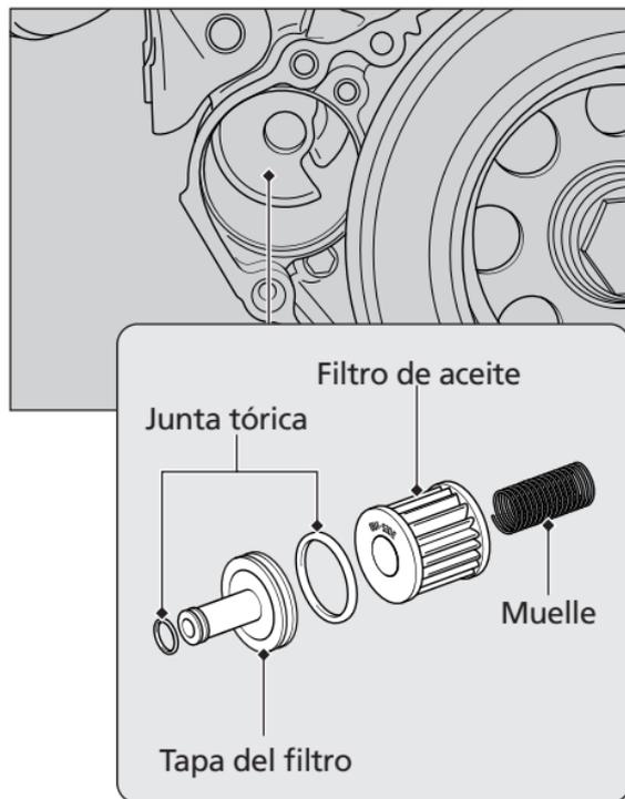
14. Instale el nuevo filtro de aceite dentro del cárter con la marca "OUT SIDE" hacia fuera.
