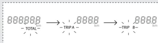
Para poner a cero el "TRIP A" o "TRIP B" en modo de distancia recorrida o tiempo de conducción, seleccione la condición deseada y mantenga presionado el botón (SET) durante más de dos segundos.
