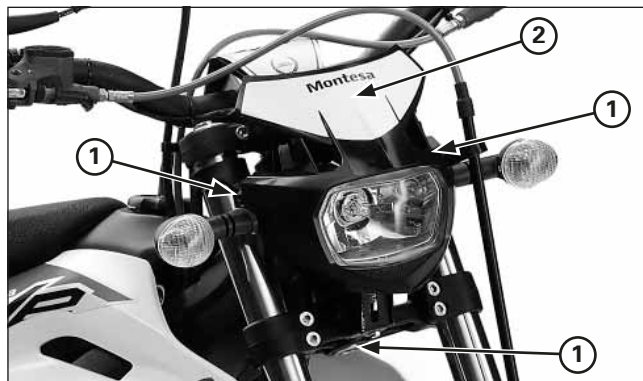
(1) TORNILLOS (2) CARCASA DE FARO
