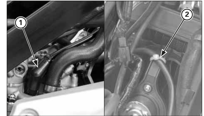
(1) PIPETA DE LA BUJÍA (2) BRIDA
