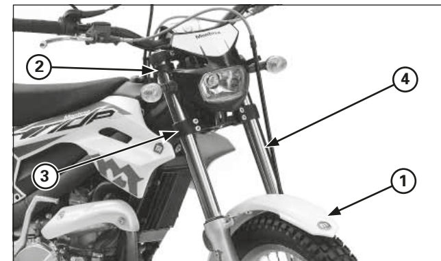
(1) GUARDABARROS DELANTERO (2) PUENTE SUPERIOR (3) PUENTE INFERIOR (4) BARRA DE LA HORQUILLA
