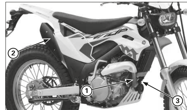
(1) TUBO DE ESCAPE (2) SILENCIADOR (3) Sonda LAMBDA
