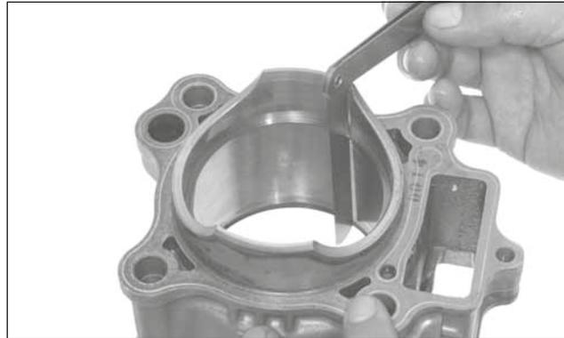
Inserire le fasce elastiche nel cilindro e misurarne la distanza tra le estremità.
