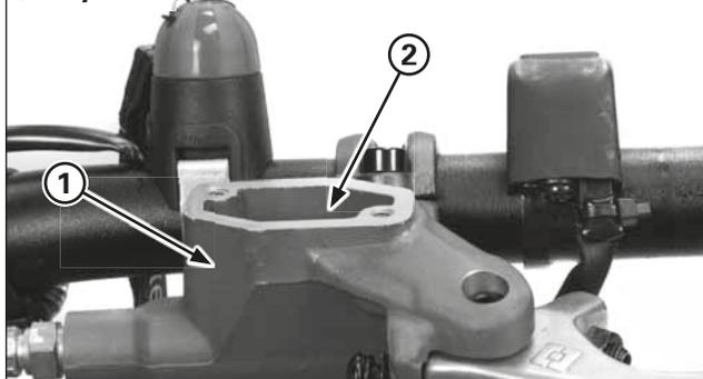
(1) SERBATOIO DEL LIQUIDO DELLA FRIZIONE
