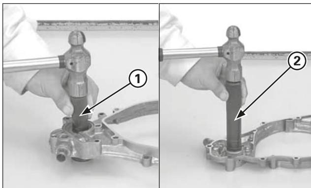
(1) INSERITORE DELLA GUARNIZIONE IDRAULICA
