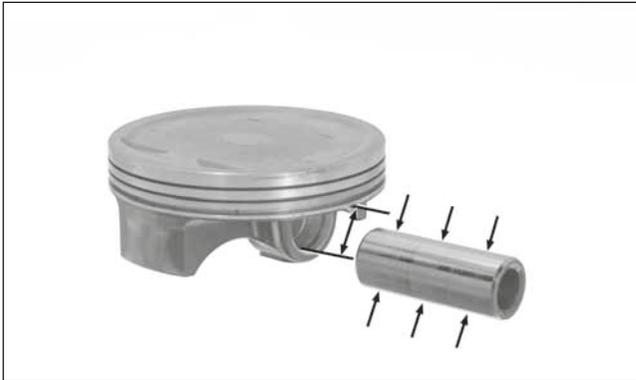
Misurare il D.E. del pistone a 3,0 mm dall'estremità inferiore del mantello e 90 gradi sino al foro dello spinotto.
