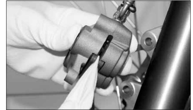
Premere i pistoni completamente in dentro per agevolare l'installazione delle nuove pastiglie del freno.
