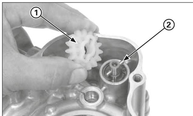
(1) INGRANAGGIO CONDOTTO DELLA POMPA DELL'OLIO
