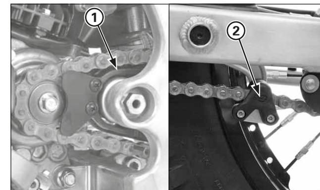
(1) GUIDA DELLA CATENA DI TRASMISSIONE
