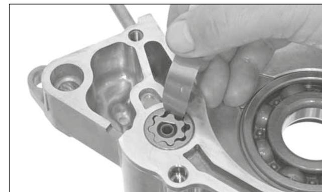
Controllare se il paraolio dell'alberino della pompa che si trova nel carter sinistro è danneggiato o deteriorato. Se necessario, sostituirlo.
