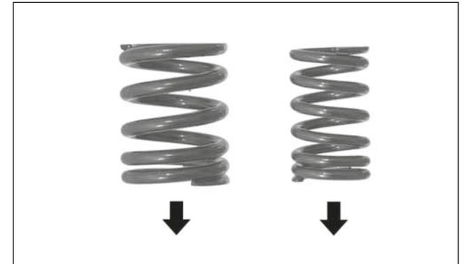
Collocare le molle della valvola con la parte della spirale più stretta rivolta verso la camera di combustione. Collocare i dispositivi di ritegno delle molle.
