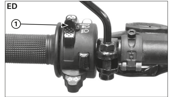
(1) INTERRUPTOR DE INTENSIDAD DE LA LUZ DEL FARO
