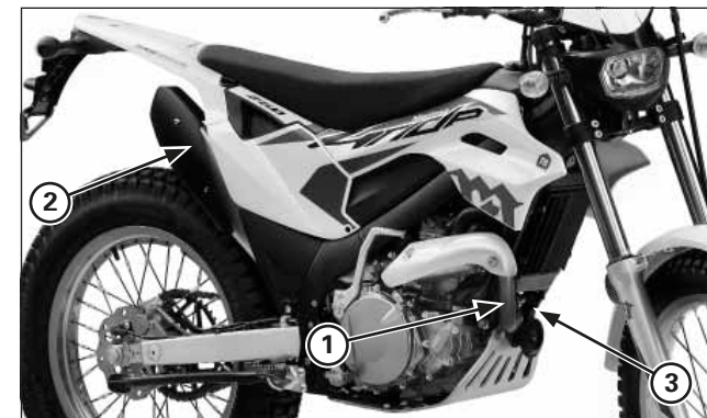
(1) TUBO DE ESCAPE (2) SILENCIADOR (3) SONTA LAMBDA
